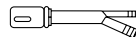
Tubería con separación de aire para manguera de desagüe (si se requiere)
